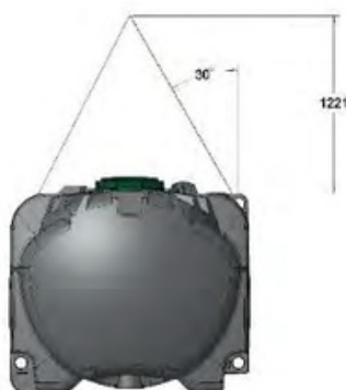
Figure 27 : manutention de la FTE seule
